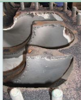
A gödrösödés és az erózió egyértelműen látható
