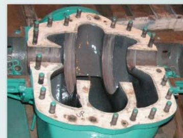
A teljesen megtisztított elhasználódott felület
